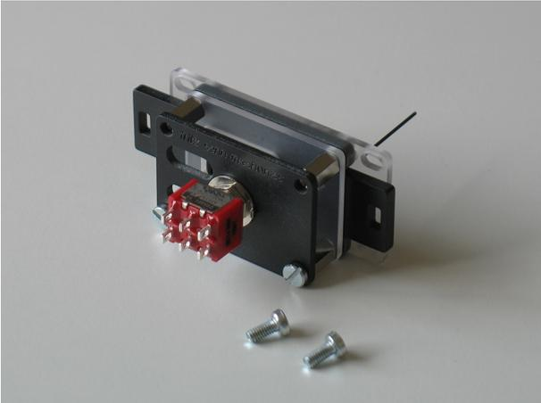
⇒ Die Schalterplatte wird mit 4 Zylinderkopfschrauben M 3 x 8 unter die Drehmechanikebene geschraubt. Darauf achten, dass sich die ovalen Aussparungen auf der Stelldrahtseite befinden.
