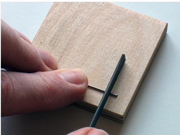
Die schmale Kante einer Nadelfeile wird mit etwas Druck über den Draht gerollt (nicht feilen), so dass sich eine Prägung abzeichnet.
